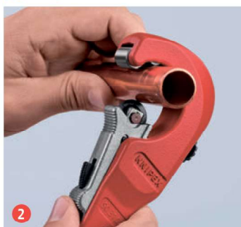
2 Прижмите режущий диск к трубе одной рукой. Система быстрой регулировки QuickLock обеспечивает очень быструю подстройку к трубам разного диаметра
