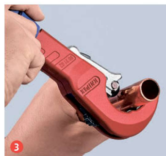
3 Начинайте рез, постепенно регулируя положение режущего диска специальным синим вентиляем на конце рукоятки
