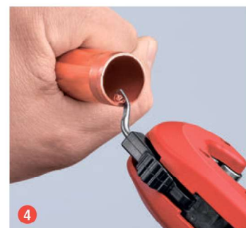
4 Опционально: по завершении реза, по мере необходимости, удалите заусенцы с кромки трубы при помощи гратоснимателя. Это не займёт много усилий!
