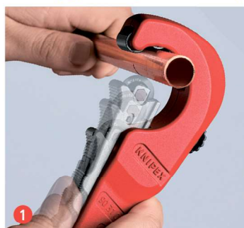
1 Поместите трубу в раскрытый труборез KNIPEX TubiX®
